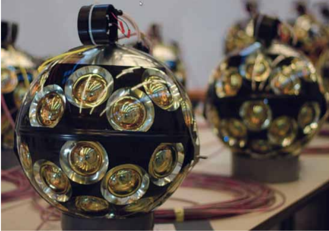
The 'eyes' of KM3NeT: The DOM's made of pressure resistant glass spheres measuring each about 43cm in diameter. Die Augen von KM3NeT: Die DOMs aus druckfesten Glaskugeln haben einen Durchmesser von ca. 43cm. Image: KM3NeT
